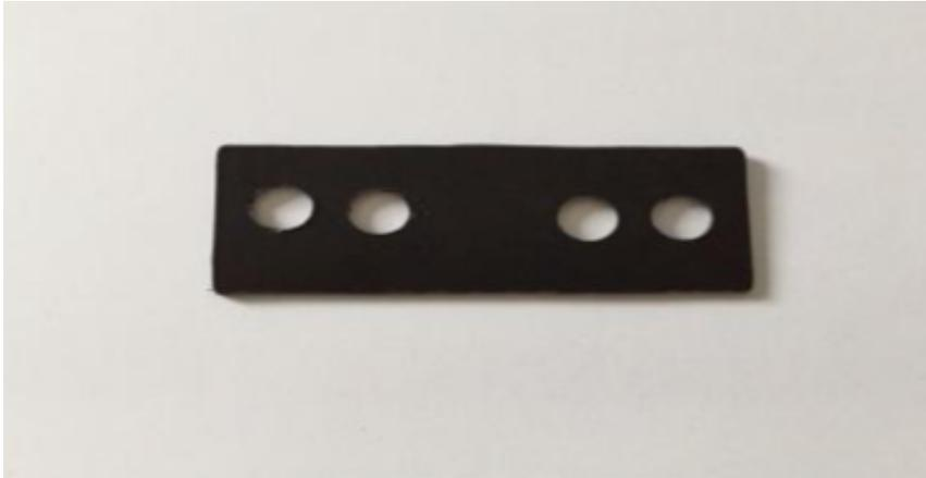
Der Verbinder ist eine Platte aus festem Kunststoff oder beschichtetem Metall mit mehreren Bohrungen, durch die der Anker durchgeführt und in den Sack eingetrieben wird. Er dient dazu, gefüllte, nebeneinander liegende Säcke zu verbinden.
